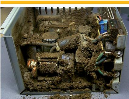
**Bild 1: Verunreinigungen im Elektroniksystem, hervorgerufen durch Lüfertechnologie. Das abgelagerte Material besteht aus Fasern, Bakterien, Viren, Feuchtigkeit sowie Hautschuppen.**
